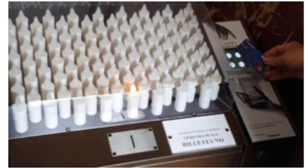
Esta solución novedosa consiste en un lampadario electrónico con tecnología LED que **conecta el sistema de encendido de velas electrónicas con el sistema de pago contactless**, mediante tarjetas y dispositivos NFC.<sup>1</sup>
